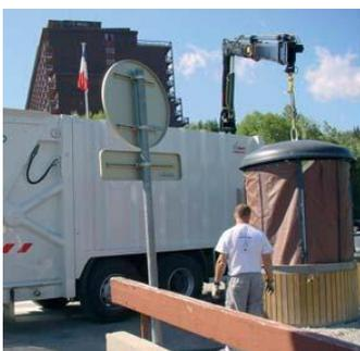
**Die Leerung** erfolgt mit den gebräuchlichen Systemen Fahrzeug mit Kranarm
