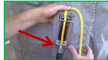
4.) Das Seil in der Klemme festhalten und die Sicherheitsklammer hinter dem Schlauchhalter einrasten.
