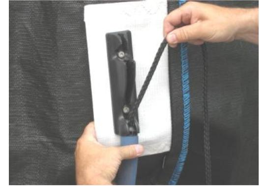
3.) Den Schlauch in den unteren Teil der Seilklemme einsetzen.
